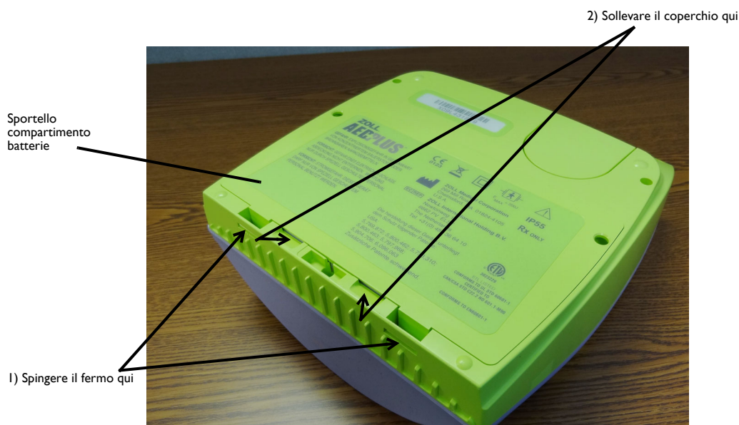
Figura 7: Togliere lo sportello del compartimento batterie
