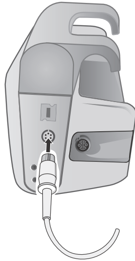
Abbildung 11-1 Anschließen des Messwandlers an das Propaq MD
