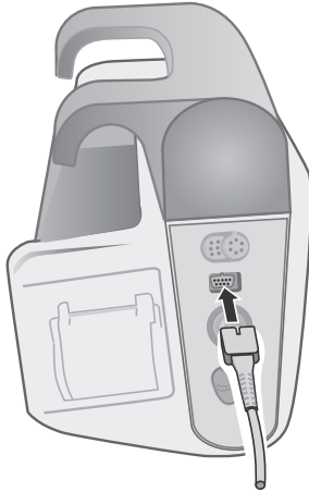
Abbildung 9-1 Anschließen des SpO 2 -Sensors an das Propaq MD Gerät
