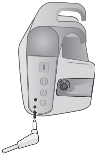
Abbildung 12-1 Anschließen der Temperatursonde am Propaq MD Gerät
