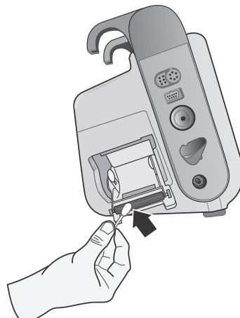
Abbildung 18-3. Reinigen des Druckkopfs
