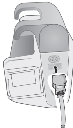
Abbildung 10-3 Anschließen des SpO 2 -Sensors an das Propaq MD Gerät
