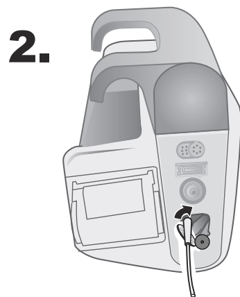
Abbildung 9-1 Anschließen des Messleitungsanschlusses am CO 2 -Einlass
