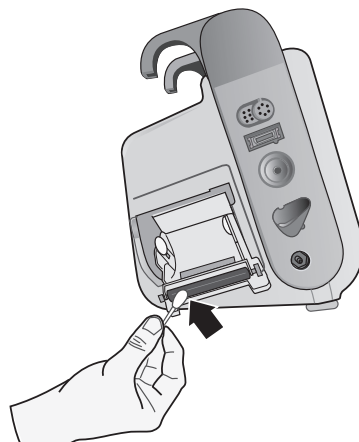
Abbildung 24-3. Reinigen des Druckkopfs
