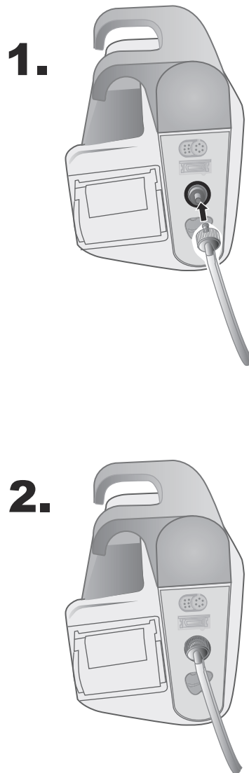
Abbildung 8-1 Anbringen eines Doppellumenschlauchs am Propaq MD Gerät
