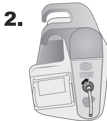
Abbildung 8-2 Anbringen eines einlumigen Schlauches am Propaq MD Gerät
