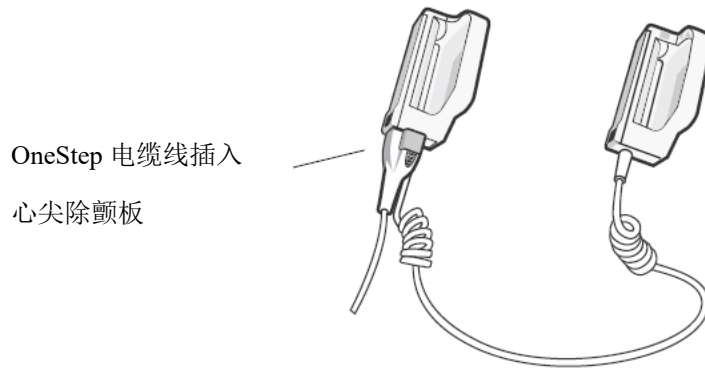
图 2-8 将 OneStep 电缆线插入心尖除颤板中
