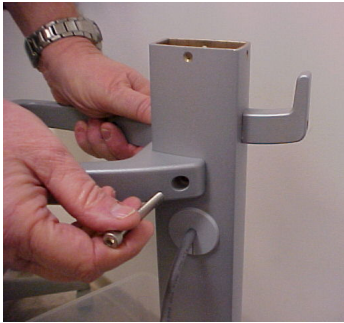
Afbeelding 3.3. De handgreep vastzetten met de lange bout en middelste schroef
