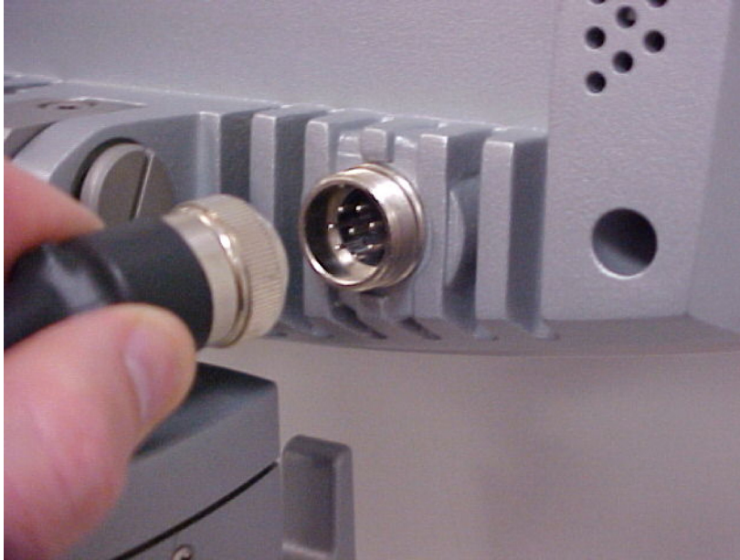
Afbeelding 3.5. De stekker van de besturingskabel in de aansluiting steken
