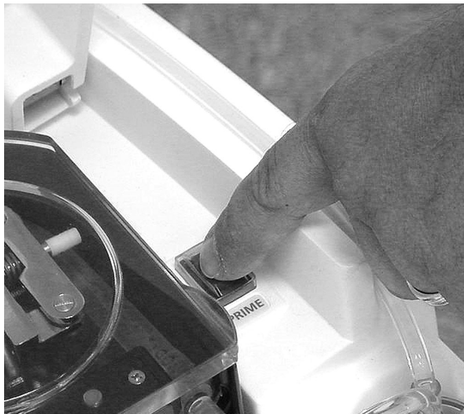
Afbeelding 4.45. De primeschakelaar gebruiken om het slangcircuit te primen
