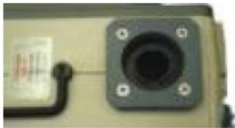
使用止血钳或镊子取出圆盘过滤器，换上新的、干净的过滤器，并确保过滤器平坦的被嵌入，高度不超过机器侧面。
