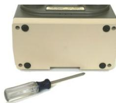
**警告!** 在试图更换电池 (ZOLL PN 703-0731-01) 之前, 确保外接电源断开, 呼吸机电源处于关闭状态。
