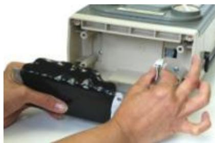
调整插头, 然后插入插座。插头和插座都是“锁着的”以防止错接。立刻将呼吸机开机, 呼吸机将会出现 *DISCONNECT* 断开报警, 然后关闭呼吸机。
