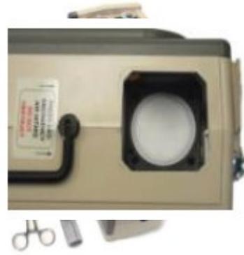
**警告！** 取出过滤器之前，应确保已经断开外接电源、呼吸机处于关闭状态。
