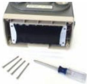
取下 4 个螺钉, 它们作用是把电池组及其完整支架固定在呼吸机的下壳上。
