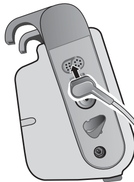
Collegamento del cavo ECG all'unità Propaq M
