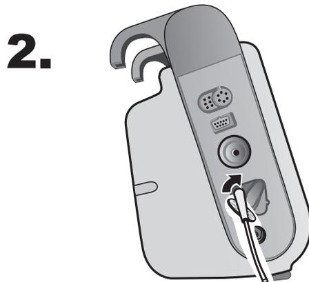
**Collegare il connettore della linea di campionamento alla porta di ingresso della CO<sub>2</sub>.**
