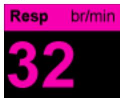
Il misuratore della respirazione visualizza la frequenza respiratoria che ricava, per impostazione predefinita, dalla funzione di monitoraggio CO<sub>2</sub> dell'unità. Se il monitoraggio CO<sub>2</sub> non è disponibile, l'unità ricava la frequenza respiratoria tramite la *pneumografia a impedenza*, utilizzando una configurazione di elettrodi ECG specificata. Se il monitoraggio ECG non funziona, il misuratore **Resp/BR** non visualizza una frequenza respiratoria.
