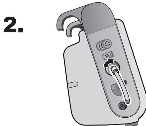
**Collegamento di un tubo a lume singolo all'unità Propaq M**
