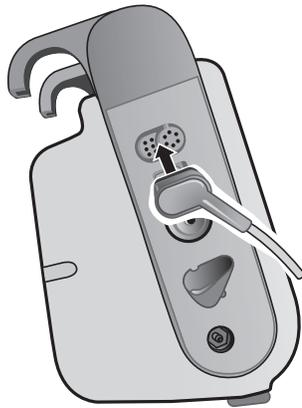
Figura 13-2 Collegamento del cavo ECG a 12 derivazioni
