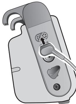
**Collegamento del cavo ECG all'unità Propaq M**
