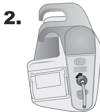
Figura 8-2 Collegamento di un tubo a lume singolo all'unità X Series
