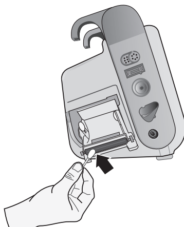
Figura 25-3. Pulizia della testina di stampa
