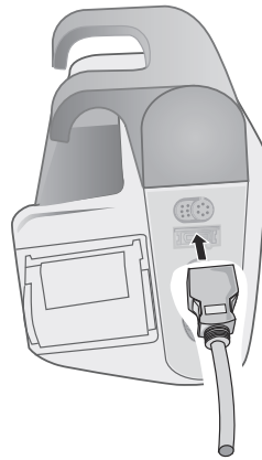
圖 10-3. 將 SpO 2 感測器連接到 X Series 裝置上
