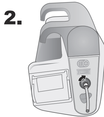
圖 8-2. 將單腔管接在 X Series 裝置上
