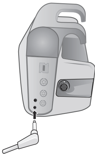
圖 12-1. 將體溫探針連接到 X Series 裝置上
