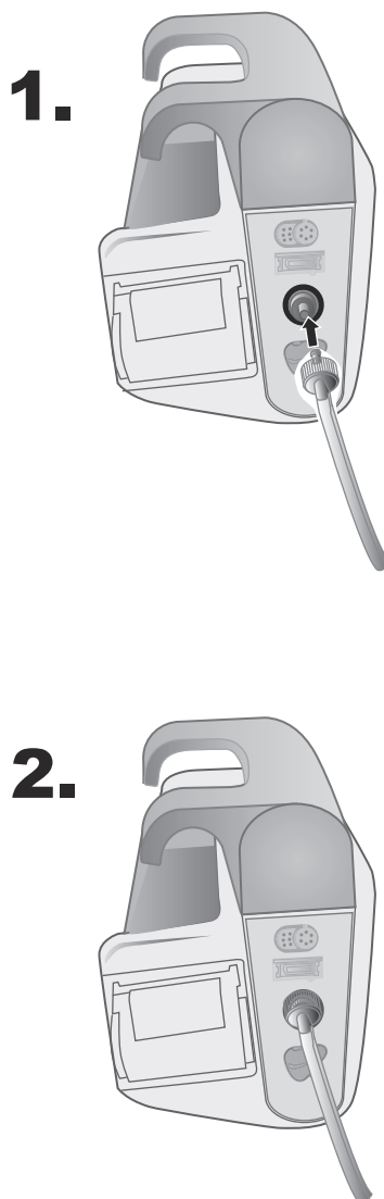
圖 8-1. 將雙腔管連接在 X Series 裝置上
