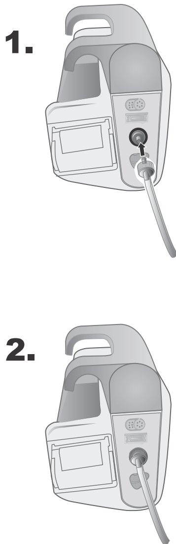
图 8-1 将双腔软管接在 X Series 设备上
