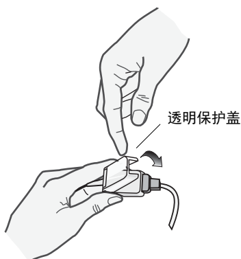
图 10-2 用塑料盖盖住电缆接口
