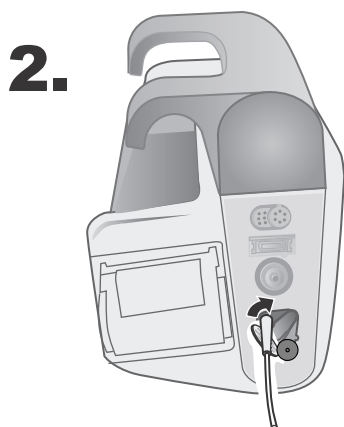
图 9-1 将采样管路接头连接到 CO 2 进气口
