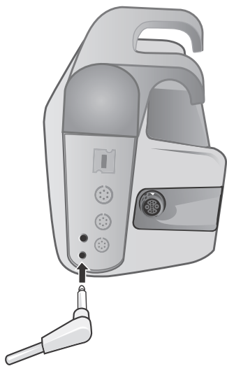
图 12-1 将体温探头连接到 X Series 设备上
