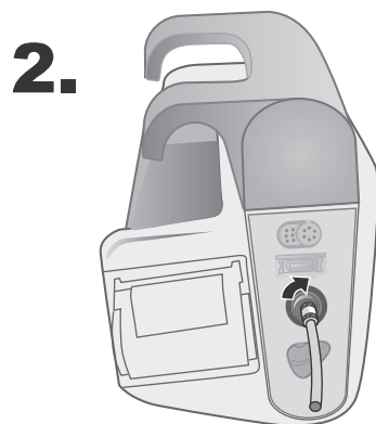
图 8-2 将单腔软管接在 X Series 设备上
